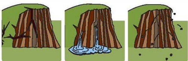
がけに割れ目が見える がけから水が湧き出ている がけから小石がぱらぱら落ちてくる
